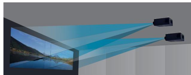
Projecteurs dotés de la fonction de fusion des bords pour la projection impeccable d'une seule image à l'aide de plusieurs projecteurs.
