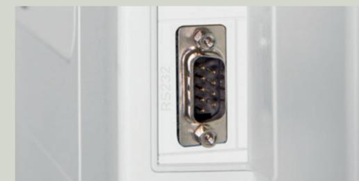
Über die RS-232C-Schnittstelle können Sie ein kompatibles Gerät an den interaktiven Flachbildschirm anschließen. Dies ermöglicht die Fernverwaltung von vielen Funktionen wie z.B. Lautstärke, Helligkeit und Kontrast.
