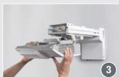
3 Projektor (mit montierter Halterung) auf den Schwenkarm schieben
